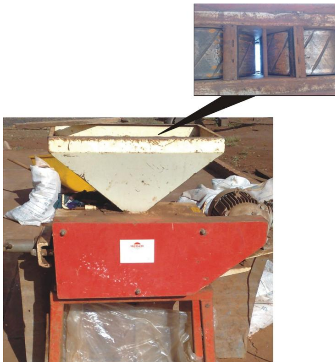
FIGURA 2. Debulhadora usada na trilha dos frutos de pinhão manso.
